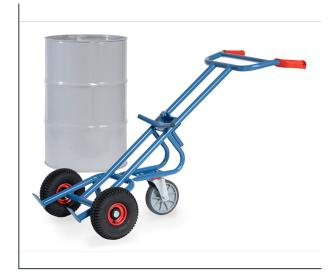
Fasskarre aus Stahlrohr geschweißt, pulverbeschichtet, blau RAL 5007, dauerhaft oberflächengeschützt. Räder mit Luftbereifung, Naben mit Rollenlager. Für alle 200-Liter-Fässer mit Rand geeignet. Zusätzlich mit 1 Stütz-Lenkrolle TPE 200 x 40 mm.
