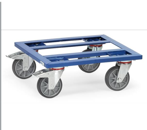
Aus Winkelstahl geschweißt, mit offenem Rahmen, pulverbeschichtet blau RAL 5007, 4 Lenkrollen, TPE-Bereifung, Naben mit Rillenkugellager. 2 Stück mit Feststeller, gemäß der Europäischen Norm EN 1757-3 (Sicherheit von Plattformwagen).
