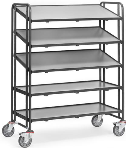
Eurokastenwagen im Baukasten-System: Stahlrohr und Profilstahl geschweißt, pulverbeschichtet anthrazitgrau RAL 7016, Schraubkonstruktion. 5 Etagenrahmen mit Holzwerkstoffplatten, Rand 13 mm hoch. Variabel einschraubbare Etagen, Raster 100 mm, Neigung bei schrägem Einbau 15° oder 30°. Tragkraft pro Ladefläche 60 kg. 4 Lenkrollen, TPE-Bereifung, Naben mit Rillenkugellager. 2 Stück mit Feststeller.
