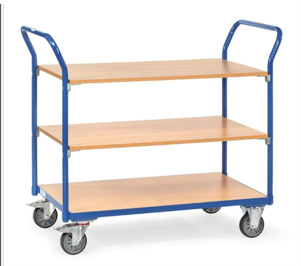
Profilstahl-/Stahlrohr-Schweißkonstruktion, pulverbeschichtet, brillantblau RAL 5007. 3 Böden aus Holzwerkstoffplatte, Oberfläche Buchendekor. 2 Lenk- und 2 Bockrollen, TPE-Bereifung, Naben mit Rillenkugellager. Feststeller an den Lenkrollen. Tragkraft mittlere und obere Ladefläche 80 kg.
