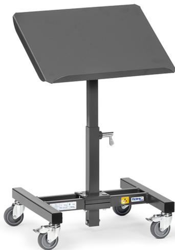
Elektrisch leitfähige Ausführung. Für Kunststoffkästen, Stahlblechkästen, Drahtkörbe, usw., höhenverstellbar und fahrbar. Profilstahl-/Rohrkonstruktion mit Stahlblechplattform mit einseitiger Anlegekante, neigbar um 15° und 30°. Höhenverstellbar im Raster von 25 mm. Pulverbeschichtet, schiefergrau RAL 7015. 4 Lenkrollen mit TPE-ESD-Bereifung, Naben mit Gleitlagerung. Feststeller an 2 Lenkrollen gemäß der Europäischen Norm EN 1757-3 (Sicherheit von Plattformwagen).
