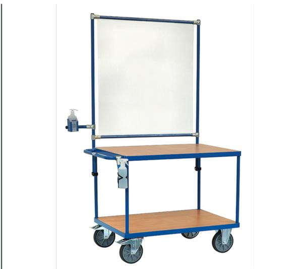
Tischwagen aus Stahlrohr und Profilstahl geschweißt, pulverbeschichtet blau RAL 5007. 2 Plattformen aus Holzwerkstoffplatte, Oberfläche Buchendekor. 2 Lenk- und 2 Bockrollen, TPE-Bereifung, Naben mit Rillenkugellager. Feststeller an den Lenkrollen. Tragkraft obere Ladefläche 200 kg. Zusätzlich ausgestattet mit Infektionsschutzwand 5901, Desinfektionsmittelhalterung 1393-B0500 (für 500 ml Bode-Flasche) und Sprühflaschenhalterung 1391. (Flaschen nicht im Lieferumfang enthalten)
