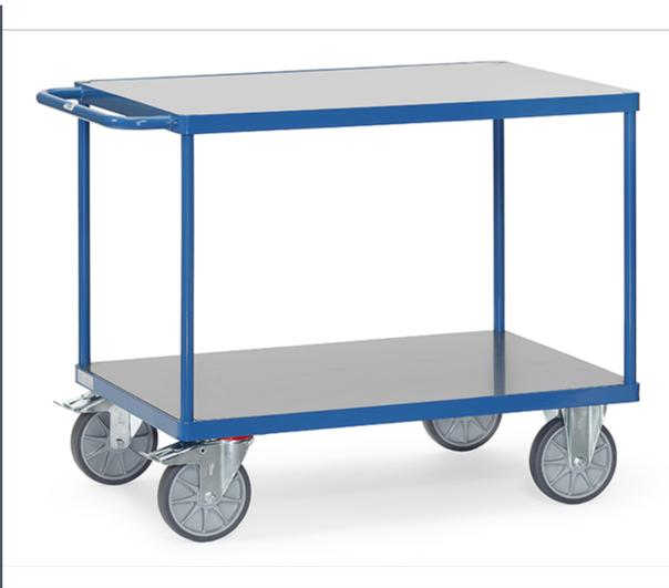
Stahlrohr und Profilstahl geschweißt, pulverbeschichtet RAL 5007. Mit zwei Plattformen mit Ladeflächen aus Hart-PVC. 2 Lenk- und 2 Bockrollen, TPE-Bereifung, Naben mit Rillenkugellager. Feststeller an den Lenkrollen. Tragkraft obere Ladefläche 200 kg.
