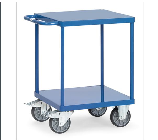
Stahlrohr und Profilstahl geschweißt, pulverbeschichtet brillantblau RAL 5007. 2 Plattformen aus Stahlblech, bündig im Rahmen, sauber eingeschweißt, ebenfalls pulverbeschichtet RAL 5007. 2 Lenk- und 2 Bockrollen, TPE-Bereifung, Naben mit Rillenkugellager. Feststeller an den Lenkrollen. Tragkraft obere Ladefläche 200 kg.
