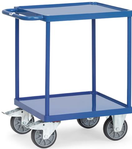
Stahlrohr und Profilstahl geschweißt, pulverbeschichtet brillantblau RAL 5007. 2 Stahlblechwannen mit 10 mm hohem Rand, öldicht verschweißt, pulverbeschichtet RAL 5007. 2 Lenk- und 2 Bockrollen, TPE-Bereifung, Naben mit Rillenkugellager. Feststeller an den Lenkrollen. Tragkraft obere Ladefläche 200 kg.
