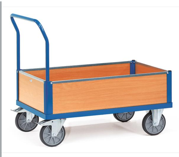
Stahlrohr und Profilstahl geschweißt, pulverbeschichtet RAL 5007, Plattform Holzwerkstoffplatte, Oberfläche Buchendekor. 4 Wände aus Holzwerkstoffplatte, Oberfläche Buchendekor, Wandhöhe 250 mm. Alle 4 Wände sind einzeln herausnehmbar. 2 Lenk- und 2 Bockrollen, TPE-Bereifung, Naben mit Rillenkugellager. Feststeller an den Lenkrollen.
