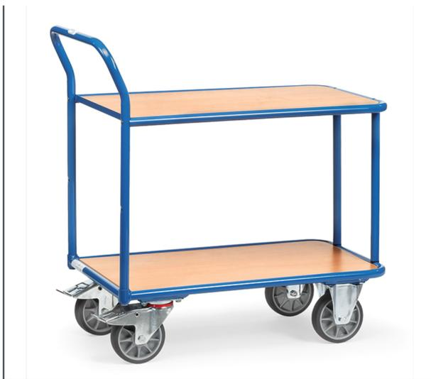
Tischwagen aus Profilstahl-/Stahlrohr-Schweißkonstruktion, pulverbeschichtet, brillantblau RAL 5007. 2 Böden aus Holzwerkstoffplatte, Oberfläche Buchendekor. 2 Lenk- und 2 Bockrollen, TPE-Bereifung, Naben mit Rillenkugellager. Feststeller an den Lenkrollen.
