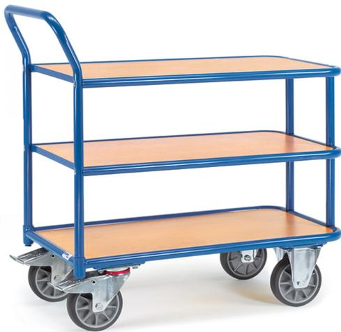
Tischwagen aus Profilstahl-/Stahlrohr-Schweißkonstruktion, pulverbeschichtet, brillantblau RAL 5007. 3 Böden aus Holzwerkstoffplatte, Oberfläche Buchendekor. 2 Lenk- und 2 Bockrollen, TPE-Bereifung, Naben mit Rillenkugellager. Feststeller an den Lenkrollen.
