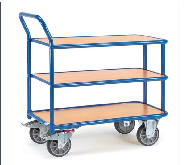
Tischwagen aus Profilstahl-/Stahlrohr-Schweißkonstruktion, pulverbeschichtet, brillantblau RAL 5007. 3 Böden aus Holzwerkstoffplatte, Oberfläche Buchendekor. 2 Lenk- und 2 Bockrollen, TPE-Bereifung, Naben mit Rillenkugellager. Feststeller an den Lenkrollen.
