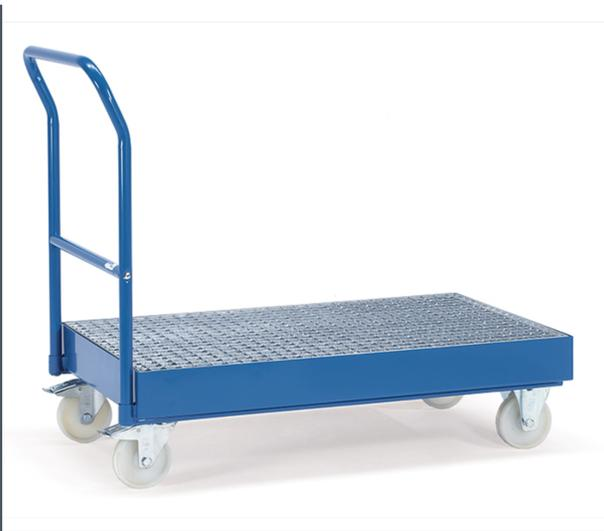
Stahl-Konstruktion geschweißt, Wanne 100 mm hoch, öldicht, pulverbeschichtet blau RAL 5007. Mit bündig eingelegtem Gitterrost, Maschenweite 31 x 31 mm, feuerverzinkt. 2 Lenk- und 2 Bockrollen, Naben mit Rollenlagerung. Feststeller an den Lenkrollen, gemäß der Europäischen Norm EN 1757-3 (Sicherheit von Plattformwagen). Zum Transport von 1 oder 2 200-Liter-Fässer geeignet. Verhindert Schäden durch Tropföl. Auffangwanne 45 Liter.
