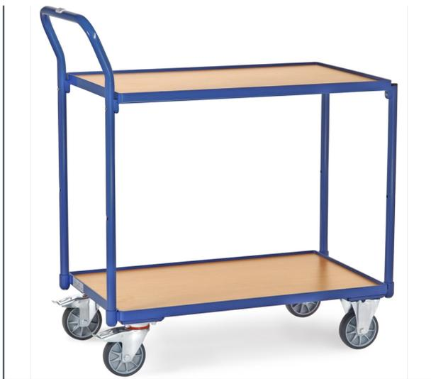
Leichter Tischwagen im Baukasten-System. Stahlrohr und Profilstahl geschweißt, pulverbeschichtet. Schraubkonstruktion. 2 Böden aus Holzwerkstoffplatte, Oberfläche Buchendekor, im Stahlrahmen liegend, Rand 12 mm hoch. Schiebegriff hochstehend. 2 Lenk- und 2 Bockrollen, TPE-Bereifung, Naben mit Rillenkugellager. Feststeller an den Lenkrollen. Tragkraft obere Ladefläche 80 kg.
