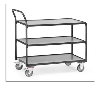
Leichter Tischwagen aus Stahlrohr und Profilstahl geschweißt, pulverbeschichtet anthrazitgrau RAL 7016. Schraubkonstruktion. 3 Böden aus Holzwerkstoffplatte, Oberfläche mittelgrau, im Stahlrahmen liegend mit 12 mm hohen Rand. Schiebegriff hochstehend. 2 Lenk- und 2 Bockrollen, TPE-Bereifung, Naben mit Rillenkugellager. Feststeller an den Lenkrollen. Tragkraft obere und mittlere Ladefläche 80 kg.
