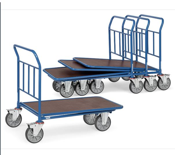
C+C-Wagen (Baumarktwagen / Einkaufswagen) - Stahlrohrkonstruktion, pulverbeschichtet, Ladefläche mit rutschsicherer Siebdruckplatte aus wasserfestem Sperrholz. 2 Lenk- und 2 Bockrollen, TPE-Bereifung, Naben mit Rillenkugellager. Feststeller an den Lenkrollen, gemäß der Europäischen Norm EN 1757-3 (Sicherheit von Plattformwagen). Ineinanderschiebbare Wagen, dadurch 75% Stellraum-Einsparung.
