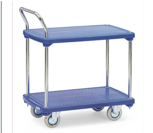
Tischwagen mit 2 Etagen. Plattformen aus Kunststoff gespritzt mit rutschhemmender Oberfläche (Farbe blau). Rohrschiebebügel feststehend, glanzverzinkt. 2 Lenk- und 2 Bockrollen, Vollgummibereifung blaugrau spurlos. Feststeller an den Lenkrollen, gemäß der Europäischen Norm EN 1757-3. Tragkraft obere Ladefläche 80 kg. Zerlegte Anlieferung.
