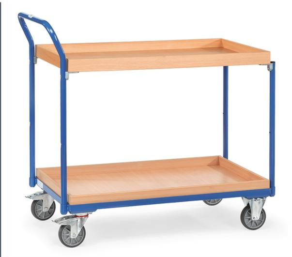
Stahlrohr und Profilstahl geschweißt, pulverbeschichtet brillantblau RAL 5007. Schraubkonstruktion. 2 Kästen aus Holzwerkstoffplatte mit 45 mm hohem Rand, Oberfläche Buchendekor. Schiebegriff hochstehend. 2 Lenk- und 2 Bockrollen, TPE-Bereifung, Naben mit Rillenkugellager. Feststeller an den Lenkrollen. Tragkraft obere Ladefläche 80 kg. Kasten-Innenabmessungen obere Etage: 965 x 555 x 45 mm.
