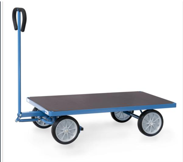
Aus Profilstahl und Stahlrohr geschweißt, pulverbeschichtet brillantblau RAL 5007. Ladefläche aus wasserfestem Sperrholz. Drehschemel-Lenkung mit Deichsel und Handgriff. Räder mit Vollgummibereifung, Naben mit Rollenlager. Deichsel mit Sicherheitshandgriff mit Softgripbezug und automatischer gedämpfter Rückstellung in Ruheposition. Automatische Feststellbremse auf die Vorderräder wirkend.
