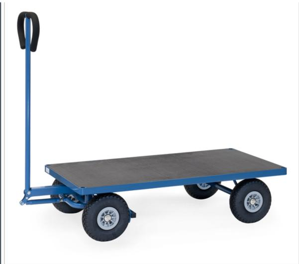
Aus Profilstahl und Stahlrohr geschweißt, pulverbeschichtet blau RAL 5007. Ladefläche aus wasserfestem Sperrholz. Drehschemel-Lenkung mit Deichsel und Handgriff. Räder mit Luftbereifung, Naben mit Rollenlager. Deichsel mit Sicherheitshandgriff mit Softgripbezug und automatischer gedämpfter Rückstellung in Ruheposition. Automatische Feststellbremse auf die Vorderräder wirkend.
