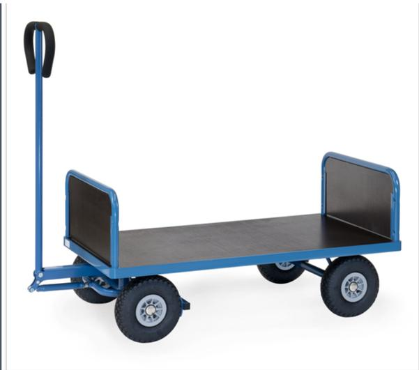
Aus Profilstahl und Stahlrohr geschweißt, pulverbeschichtet brillantblau RAL 5007. Ladefläche aus wasserfestem Sperrholz, mit 2 Stirnwänden 300 mm hoch, Stahlrohrrahmen mit wasserfesten Sperrholz. Drehschemel-Lenkung mit Deichsel und Handgriff. Räder mit Luftbereifung, Naben mit Rollenlager. Deichsel mit Sicherheitshandgriff mit Softgripbezug und automatischer gedämpfter Rückstellung in Ruheposition. Automatische Feststellbremse auf die Vorderräder wirkend.
