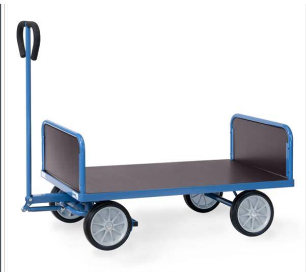
Aus Profilstahl und Stahlrohr geschweißt, pulverbeschichtet brillantblau RAL 5007. Ladefläche aus wasserfestem Sperrholz, mit 2 Stirnwänden 300 mm hoch, Stahlrohrrahmen mit wasserfesten Sperrholz. Drehschemel-Lenkung mit Deichsel und Handgriff. Räder mit Vollgummibereifung, Naben mit Rollenlager. Deichsel mit Sicherheitshandgriff mit Softgripbezug und automatischer gedämpfter Rückstellung in Ruheposition. Automatische Feststellbremse auf die Vorderräder wirkend.
