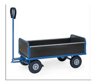
Aus Profilstahl und Stahlrohr geschweißt, pulverbeschichtet brillantblau RAL 5007. Mit Ladefläche, 2 Stirnwänden 300 mm hoch (Stahlrohrrahmen mit wasserfesten Sperrholz) und 2 Einstecklängswänden aus wasserfesten Sperrholz 220 mm hoch. Drehschemel-Lenkung mit Deichsel und Handgriff. Räder mit Luftbereifung, Naben mit Rollenlager. Deichsel mit Sicherheitshandgriff mit Softgripbezug und automatischer gedämpfter Rückstellung in Ruheposition. Automatische Feststellbremse auf die Vorderräder wirkend.
