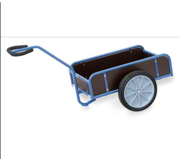
Handwagen aus Stahlrohr geschweißt, pulverbeschichtet, brillantblau RAL 5007. Anschraubbare Deichsel mit Sicherheitsgriff und hautsympathischem Softgrip-Bezug. Ladefläche aus wasserfestem Sperrholz. Mit 4 Wänden aus wasserfestem Sperrholz, 180/250 mm hoch. Räder mit Vollgummibereifung, Naben mit Rollenlager.
