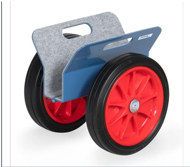
Stahl-Schweißkonstruktion, pulverbeschichtet blau RAL 5007, Klemmflächen mit Filzbelag. Sichere Klemmung durch das Gewicht des Ladegutes auf die Klappkonstruktion. Reifen mit Vollgummibereifung. Maximale Klemmbreite 0-60 mm.
