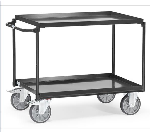
Stahlkonstruktion geschweißt. Mit 2 Stahlblechwannen. Stahlrohnbügel und Stahlblechwannen verschraubt. Wannen öldicht, Rand 40 mm hoch. Pulverbeschichtet RAL 7016 anthrazitgrau. Schiebegriff waagrecht. 2 Lenk- und 2 Bockrollen, TPE-Bereifung, Naben mit Rillenkugellager. Feststeller an den Lenkrollen. Tragkraft obere Ladefläche 200 kg.
