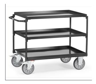
Tischwagen Stahlkonstruktion geschweißt. Mit 3 Stahlblechwannen. Stahlrohrbügel und Stahlblechwannen verschraubt. Wannen öldicht, Rand 40 mm hoch. Pulverbeschichtet anthrazitgrau RAL 7016. Schiebegriff waagerecht. 2 Lenk- und 2 Bockrollen, TPE-Bereifung, Naben mit Rillenkugellager. Feststeller an den Lenkrollen. Tragkraft obere und mittlere Ladefläche 200 kg.
