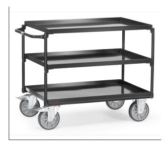
Tischwagen Stahlkonstruktion, geschweißt. Mit 3 Stahlblechwannen. Stahlrohrbügel und Stahlblechwannen verschraubt. Wannen öldicht, Rand 40 mm hoch. Pulverbeschichtet RAL 7016 anthrazitgrau. Schiebegriff waagerecht. 2 Lenk- und 2 Bockrollen, TPE-Bereifung, Naben mit Rillenkugellager. Feststeller an den Lenkrollen. Tragkraft obere und mittlere Ladefläche 200 kg.
