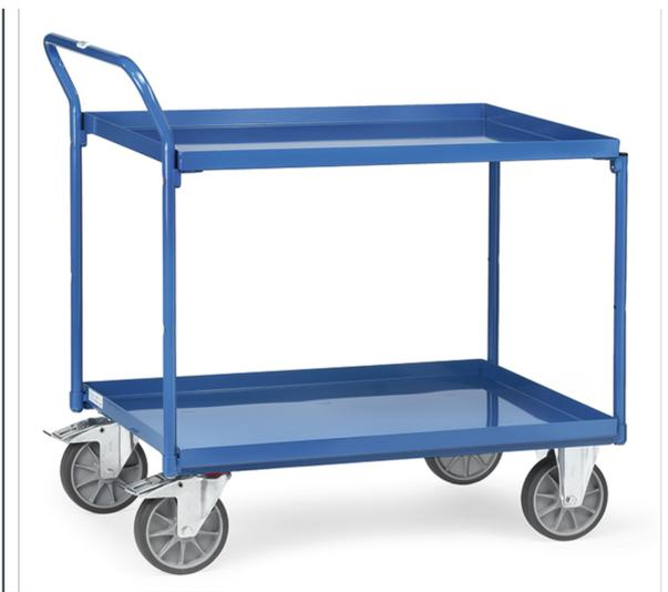
Stahlkonstruktion, geschweißt. Mit 2 Stahlblechwannen. Stahlrohrbügel und Stahlblechwannen verschraubt. Wannen öldicht, Rand 40 mm hoch. Pulverbeschichtet brillantblau RAL 5007. Schiebegriff hochstehend. 2 Lenk- und 2 Bockrollen, TPE-Bereifung, Naben mit Rillenkugellager. Feststeller an den Lenkrollen. Tragkraft obere Ladefläche 200 kg.
