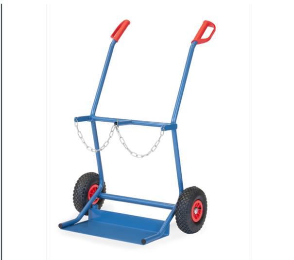
Stahlflaschenkarre aus Stahlrohr geschweißt, pulverbeschichtet blau RAL 5007. Flaschenhalterungen mit Kettensicherung. Räder mit Luftbereifung, Naben mit Rollenlager.
