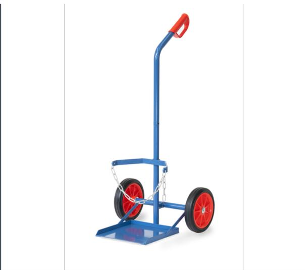
Stahlflaschenkarre aus Stahlrohr geschweißt, pulverbeschichtet blau RAL 5007. Flaschenhalterungen mit Kettensicherung. In zwei Höhen verschraubbar für 1 Propangasflasche 11 kg Ø 300 mm oder 33 kg Ø 318 mm. Räder mit Vollgummibereifung, Naben mit Rollenlager.
