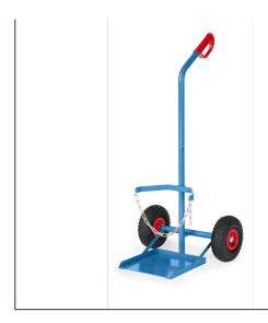
Stahlflaschenkarre aus Stahlrohr geschweißt, pulverbeschichtet blau RAL 5007. Flaschenhalterungen mit Kettensicherung. Räder mit Vollgummibereifung, Naben mit Rollenlager. Für 1 Propangasflasche 11 kg Ø 300 mm oder 33 kg Ø 318 mm.
