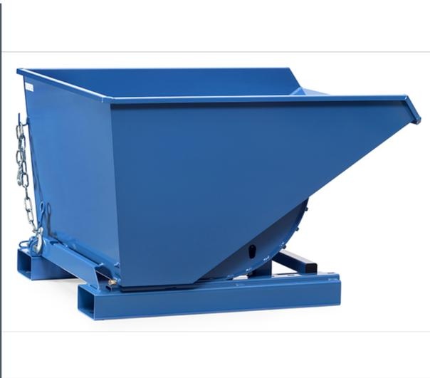
Selbstkipper müssen zum Entleeren nicht angehoben werden. Die leere Mulde geht selbsttätig in die Beladestellung zurück. Robuste Schweißkonstruktion aus 3-mm-Stahlblech, Lackierung blau RAL 5007. Serienmäßig mit Staplertaschen, Abrollsicherung und Kippverriegelung, Gliederkette als Abrutsch- und Kippsicherung. Zugseil zur Kippauslösung vom Staplersitz aus.
