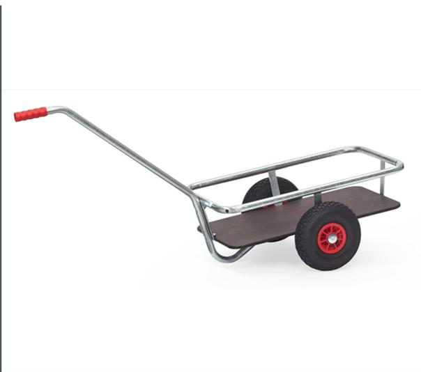
Leichter und sehr handlicher Handwagen. Aus Stahlrohr geschweißt, feuerverzinkt. Für die Verwendung im Außenbereich geeignet. Deichsel anschraubbar. Ladefläche aus wasserfestem Sperrholz. Räder mit Luftbereifung. Naben mit Rollenlager. Zerlegte Anlieferung, leichte Selbstmontage.
