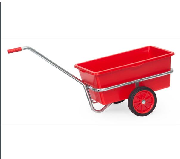
Leichter und sehr handlicher Handwagen. Aus Stahlrohr geschweißt, feuerverzinkt. Für die Verwendung im Außenbereich geeignet. Deichsel anschraubbar. Mit herausnehmbarer Kunststoffmulde. Mulde 90 Liter Inhalt, L x B x H = 715 x 420 x 320 mm. Räder mit Vollgummibereifung. Naben mit Rollenlager. Zerlegte Anlieferung, leichte Selbstmontage.
