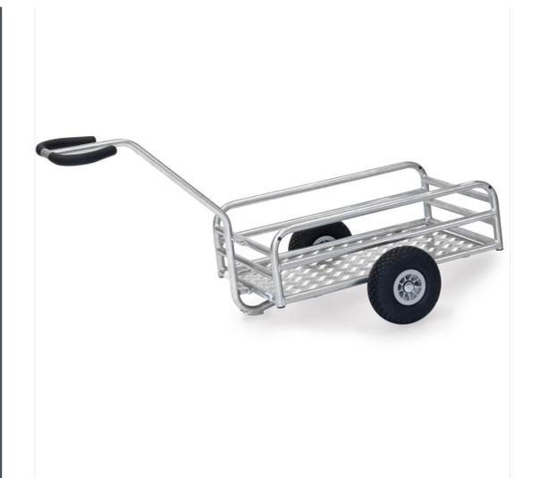
Handwagen für die Verwendung im Außenbereich. Aus Stahlrohr geschweißt, feuerverzinkt. Ladefläche aus Alu-Quintettblech. Geländer 180/250 mm hoch mit kräftigen Rohrverstreben. Anschraubbare Deichsel mit Sicherheitsgriff und hautsympathischem Softgrip-Bezug. Große Räder mit Luftbereifung, Naben mit Rollenlager. Verschraubte Radbefestigung für einfachen Radwechsel.
