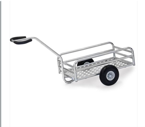
Handwagen für die Verwendung im Außenbereich. Aus Stahlrohr geschweißt, feuerverzinkt. Ladefläche aus Alu-Quintettblech. Geländer 180/250 mm hoch mit kräftigen Rohrverstreben. Anschraubbare Deichsel mit Sicherheitsgriff und hautsympathischem Softgrip-Bezug. Große Räder mit pannensicherer Polyurethanbereifung, Naben mit Rollenlager. Verschraubte Radbefestigung für einfachen Radwechsel.
