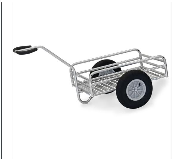
Handwagen für die Verwendung im Außenbereich. Aus Stahlrohr geschweißt, feuerverzinkt. Ladefläche aus Alu-Quintettblech. Geländer 180/250 mm hoch mit kräftigen Rohrverstreben. Anschraubbare Deichsel mit Sicherheitsgriff und hautsympathischem Softgrip-Bezug. Große Räder mit Luftbereifung, Naben mit Rollenlager. Verschraubte Radbefestigung für einfachen Radwechsel.
