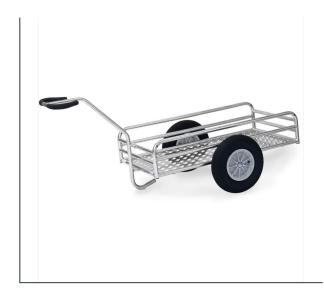
Handwagen für die Verwendung im Außenbereich. Aus Stahlrohr geschweißt, feuerverzinkt. Ladefläche aus Alu-Quintettblech. Geländer 180/250 mm hoch mit kräftigen Rohrverstrebungen. Anschraubbare Deichsel mit Sicherheitsgriff und hautsympathischem Softgrip-Bezug. Große Räder mit Luftbereifung, Naben mit Rollenlager. Verschraubte Radbefestigung für einfachen Radwechsel.
