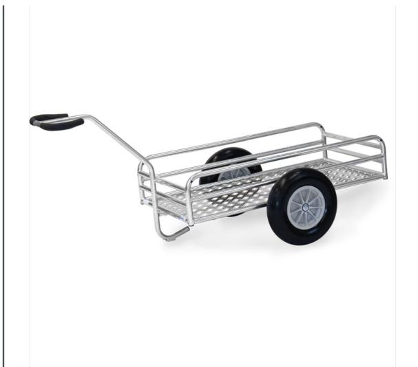
Handwagen für die Verwendung im Außenbereich. Aus Stahlrohr geschweißt, feuerverzinkt. Ladefläche aus Alu-Quintettblech. Geländer 180/250 mm hoch mit kräftigen Rohrverstrebungen. Anschraubbare Deichsel mit Sicherheitsgriff und hautsympathischem Softgrip-Bezug. Große Räder mit pannensicherer Polyurethanbereifung, Naben mit Rollenlager. Verschraubte Radbefestigung für einfachen Radwechsel.
