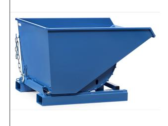
Selbstkipper müssen zum Entleeren nicht angehoben werden. Die leere Mulde geht selbsttätig in die Beladestellung zurück. Robuste Schweißkonstruktion aus 3-mm-Stahlblech, Lackierung blau RAL 5007. Serienmäßig mit Staplertaschen, Abrollsicherung und Kippverriegelung, Gliederkette als Abrutsch- und Kippsicherung. Zugseil zur Kippauslösung vom Staplersitz aus. Zusatz "A" bedeutet mit Ablasshahn und Sieb zum Trennen von Flüssigkeiten und Feststoffen.
