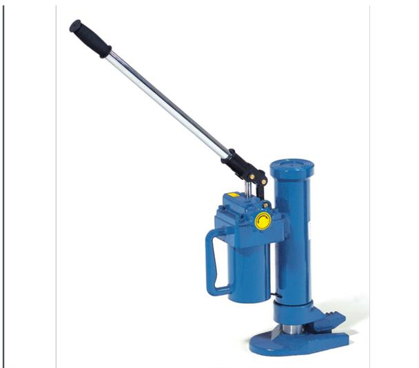
Maschinenheber zum Heben mit Hubklaue und Kopfplatte und durch eingebaute Hand-Hydraulikpumpe mit wenig Kraftaufwand möglich. Feinfühliges Senken über Senkventil, Überlastventil. Pumphebel abnehmbar. Das Gehäuse ist um 360° drehbar, in jeder Lage einsetzbar. Stabile Stahl-Kompakt-Konstruktion, Beschichtung brillantblau RAL 5007. Hubbereich an Hubklaue 6931: 25-230 mm; Hubbereich an Kopfplatte 6931: 368-573 mm.
