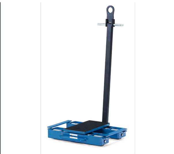
Fahrwerk für den leichten und sicheren Transport von Maschinen und anderen schweren Gegenständen. Stabile Stahl-Schweißkonstruktion, mit Handgriffen aus Rundstahl, pulverbeschichtet blau RAL 5007. Mit drehbarer Tragplatte und Zugdeichsel. Tragplatte mit rutschhemmender Gummiauflage versehen. Mit 1 Zugöse an der Deichsel. Große Stahlrollen, kugelgelagert. Lieferumfang: 1 Transportroller mit drehbarer Platte und Zugdeichsel. Garantie: 2 Jahre.
