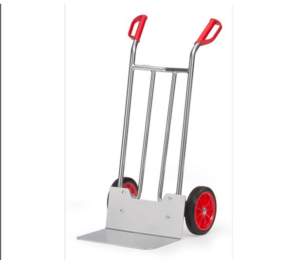
Sackkarre aus Aluminiumrohr mit Aluminiumschaufel, sehr leicht und handlich. Sauber verschweißt und "naturbelassen", Alublechschaufel anschraubbar und dadurch austauschbar. Mit Vollgummibereifung auf Kunststoff-Felgen, Naben mit Rollenlagerung. Bügel oben und Querstreben durchgebogen. Für den sicheren Transport von runden Gütern, wie Rollen, Kannen, Eimern usw.
