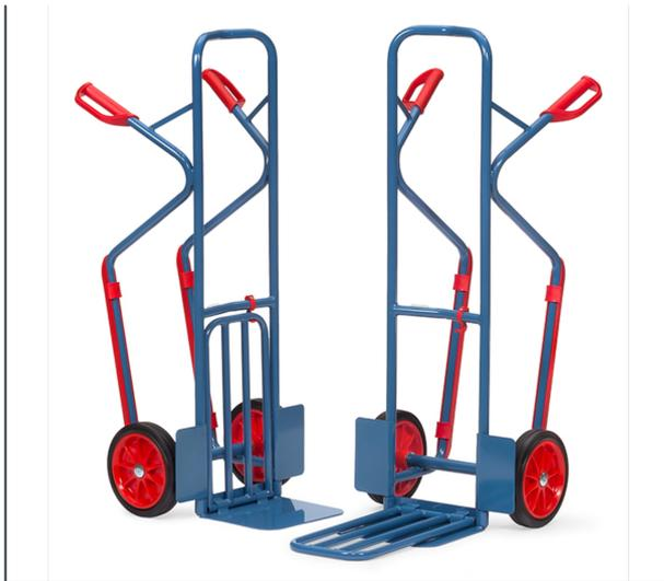
Handlich, mit großer Stahlrohr-Klappschaufel. Stabile Schweißkonstruktion, pulverbeschichtet, blau RAL 5007. Sicherheitsgriffe. Räder mit Vollgummibereifung auf Kunststoff-Felgen. Naben mit Rollenlager. Bügel oben und Querstreben durchgebogen. Für den sicheren Transport von runden Gütern, wie Rollen, Kannen, Eimern usw. Zerlegte Anlieferung.
