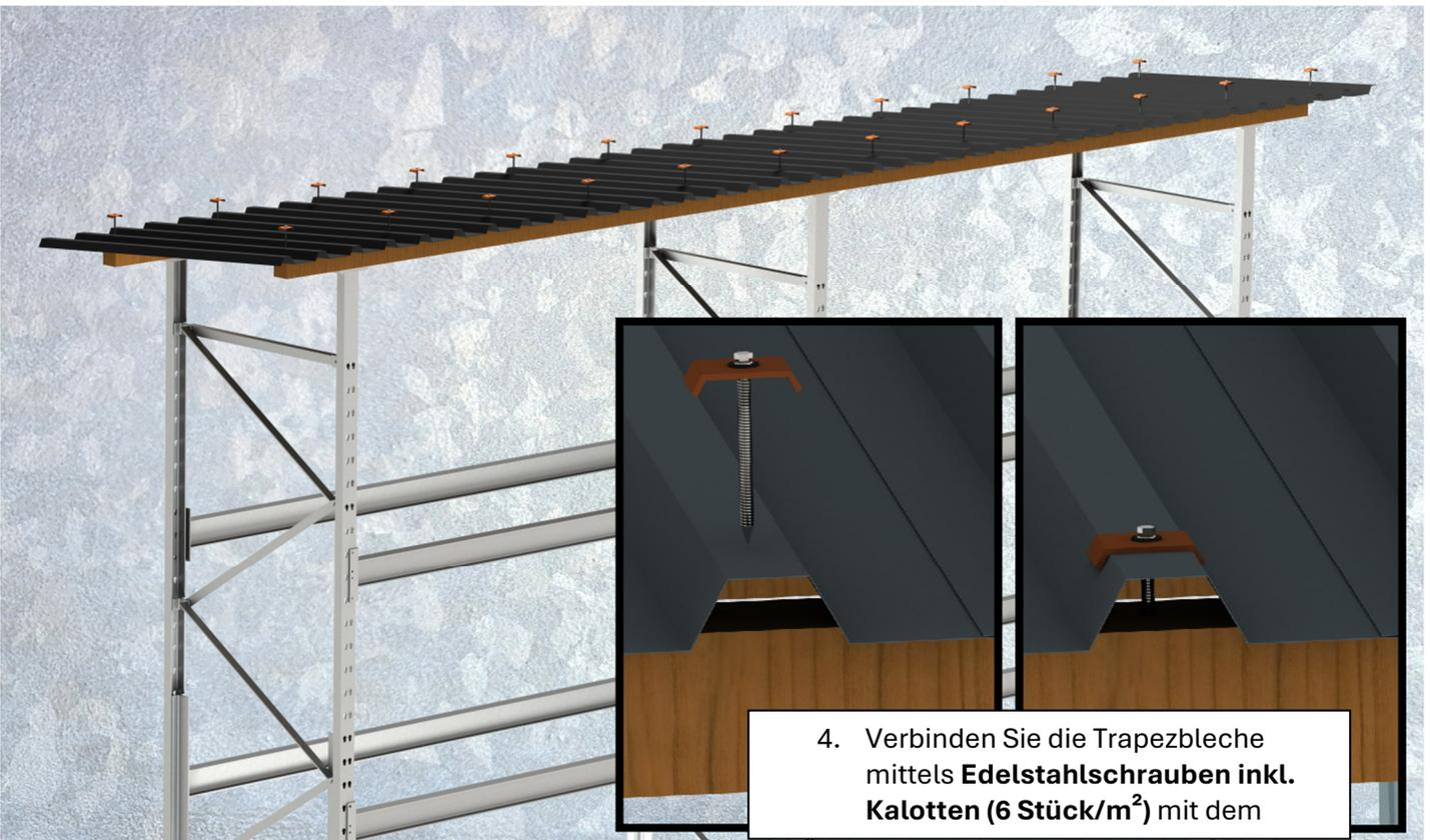
4. Verbinden Sie die Trapezbleche mittels **Edelstahlschrauben inkl. Kalotten (6 Stück/m<sup>2</sup>)** mit dem
